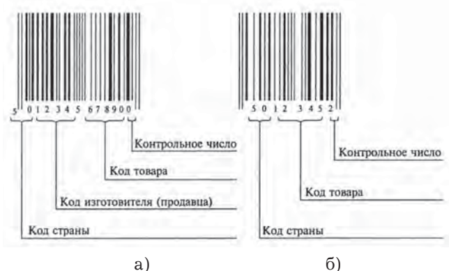
Рис. 2.5. Штриховой код: а — EAN-13; б — EAN-8
